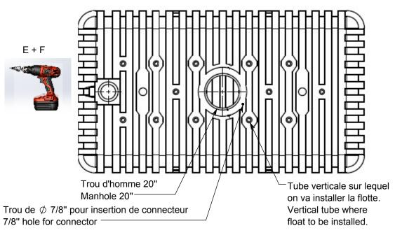
(2) Installer le connecteur (C) sur le haut de la fosse. Install connector (C) on top of tank.
