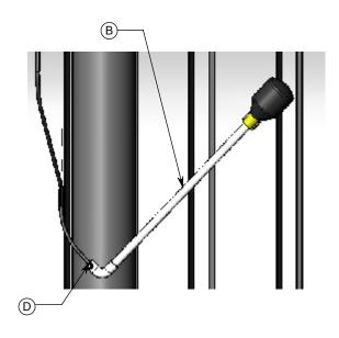
Passez le cable de la flotte à travers le connecteur (C) et prévoir un dégagement du flotteur de au moins 175 mm par rapport au trou d'homme Pass cable through connector (C) and foresee a 175 mm release to the manhole
